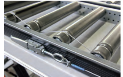
Werkstücksicherung durch Seilzugbremse Cable brake helps to secure loads
