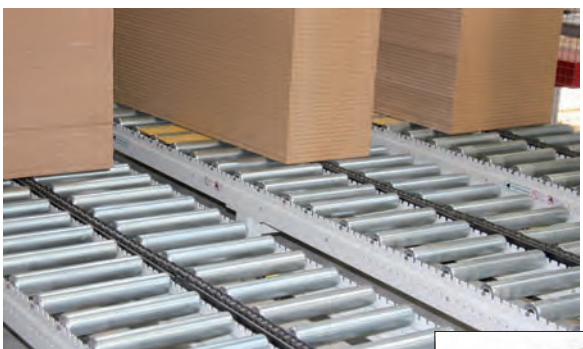
Pneumatische Hubeinheit mit Einfachrollenkette 1" Pneumatic lifting unit with 1" single-roller chain
