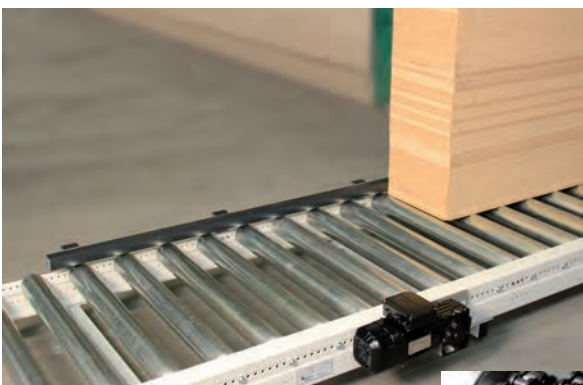
Antriebsseite mit Doppelkettenrad Drive side with double chain
