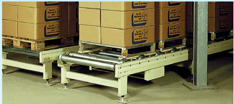
Standard-Rollenbahn Serie 389.5.K mit 5/8" Doppelkettenrädern. Bauhöhe im Bereich der Antriebsstation ab 230 mm möglich. Geeignet für den Transport von Paletten bis 2.000 kg, Tragrollenteilung 175 mm.
