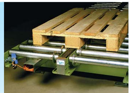
Stau-Rollenbahn Serie 461 mit der Funktion wie Serie 460, jedoch mit verstärkter 1"-Zugkette für Transportstrecken bis 15 m mit nur einem Antriebsmotor. Die Mittelkufe kann bei unterschiedlich breiten Paletten durch Bordrandscheiben geführt werden. Palettenplatzabfrage und Steuerung durch elektropneumatische Schaltkreise.
