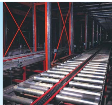
Stau-Rollenbahn Serie 460 mit pneumatisch heb- und senkbarem Kettenförderer mit 1/2"-Triplexkette, für ein Palettengewicht bis 1.200 kg.
