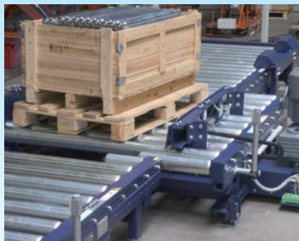
Automatische Palettenmittenzentrierung für unterschiedliche Palettengrößen.
