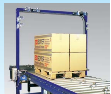
Automatische Konturenkontrolle (Länge, Breite, Höhe) im Durchlauf.
