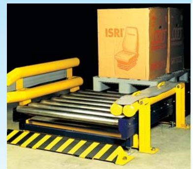
Manuell verstellbare Paletten- zentrierung mit Radanfahrerschutz für Gabelstapleraufgabe.
