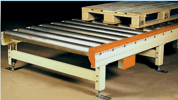
Standard-Rollenbahn Serie 389.5.K mit 5/8" Doppelkettenrädern. Bauhöhe im Bereich der Antriebsstation ab 230 mm möglich. Geeignet für den Transport von Paletten bis 2.000 kg, Tragrollenteilung 175 mm.
