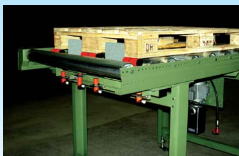
Automatische Kufen- und Freiraumkontrolle im Durchlauf.
