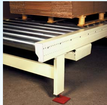
Rollenbahn Serie 380.5-K mit Tragrollen Ø 80 mm, mit Doppelkettenrädern 5/8", Tragrollenteilung 175 mm, für ein Palettengewicht bis 800 kg.
