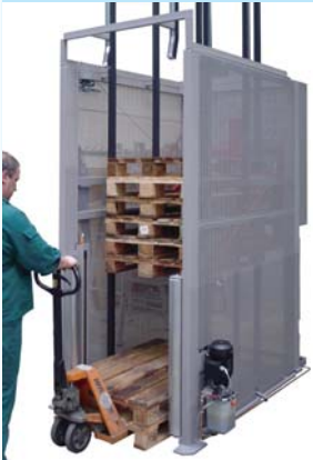
Palettenmagazin Serie 725 zur manuellen Bestückung/Entnahme mit Handhubwagen.
