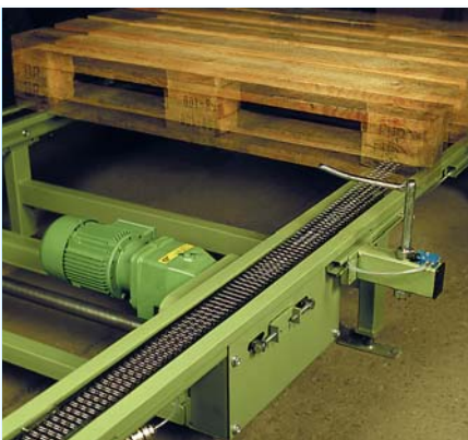
Hub-Staukettenförderer Serie 712 mit 1/2"-Triplex-oder 1"-Einfachketten. Die querstehende Palette wird pneumatisch vom Traggerüst abgehoben und auf den jeweils letzten freien Platz vorgetaktet.
