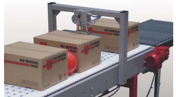
Staugliederbandförderer mit automatischer Vereinzelung Accumulation plastic belt conveyor with automatic separation
