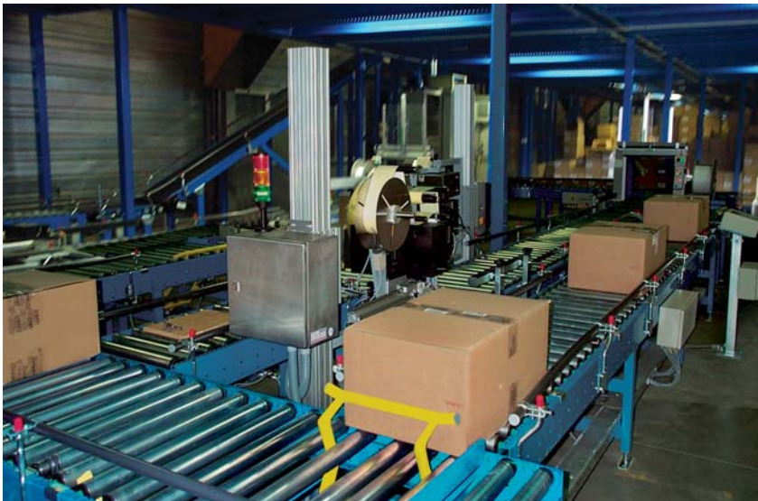
Angetriebene Rundriemen Rollenbahn Line shaft driven roller conveyor
