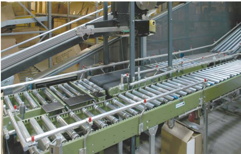
Angetriebene Rundriemen Rollenbahn Line shaft driven roller conveyor
