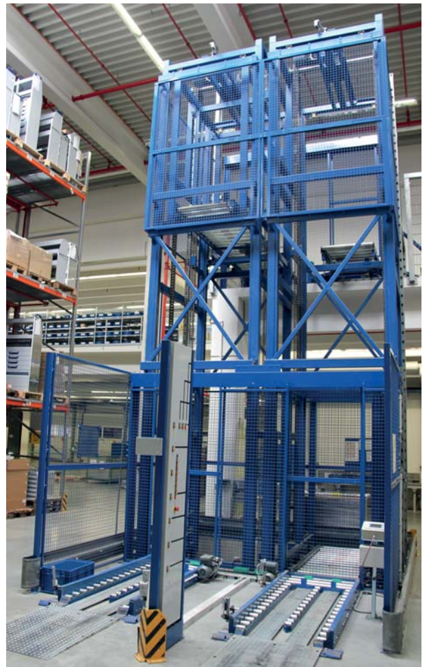
Doppelsenkrechtförderer mit Aufgabestation für Handhubwagen Twin Vertical Conveyor with Pallet Feeding Station for pallet trucks
