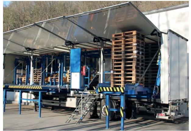
Vollautomatische Palettensortieranlage auf einem Trailer Fully automatic pallet-sorting facility mounted on a trailer
